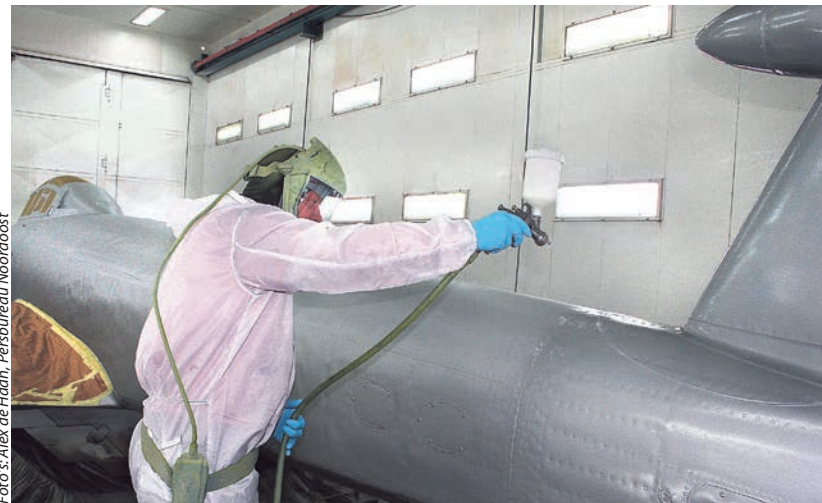
Met behulp van een conventionele bekierspuit aflakken. Het gevechtsvliegtuig hangt tijdens het spuiten aan een bovenloopkraan
