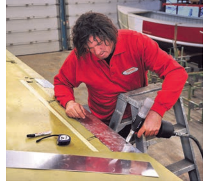
De grootste gaten afdekken en vastzetten met popnagels
