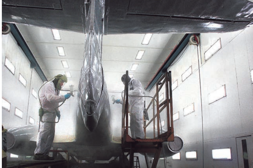
Twee medewerkers van Elzinga brengen een metallic aflak aan op de Gloster Meteor
